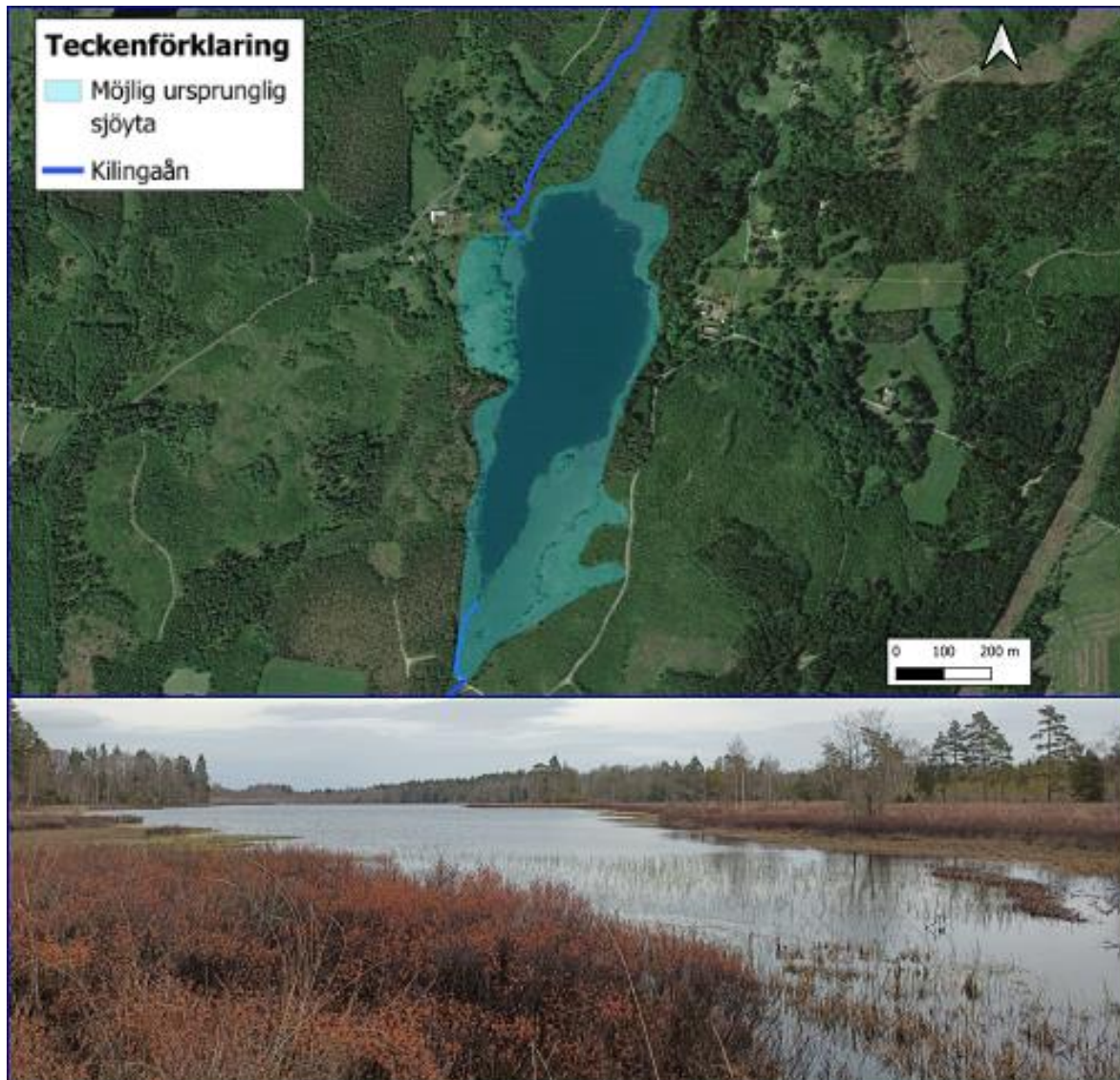
Figur 53: Sänkt sjöyta av Åbrolla sjö i Kilingaån. Ytan på övre bilden visar en möjlig ursprunglig sjöspegel. Sänkningen har lett till en uppgrundning av sjön och en kraftig igenväxning av en mycket stor del av sjöns vattenspegel. Nedre bilden visar en vy söderifrån.
